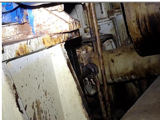
泵组驱动轴水密装置
