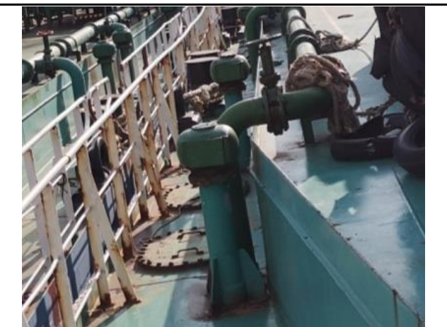
边压载舱透气管帽
