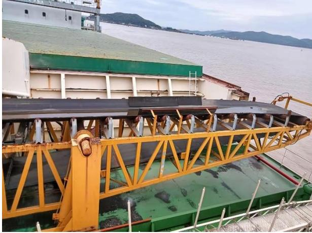
输送带装置桁架结构
