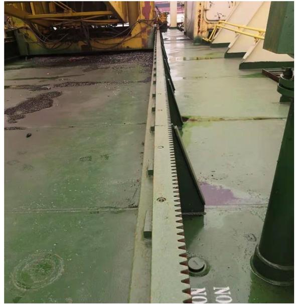
输送带装置行走齿条导轨
