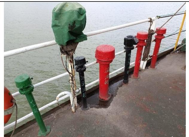
机舱油舱、污水舱透气管
