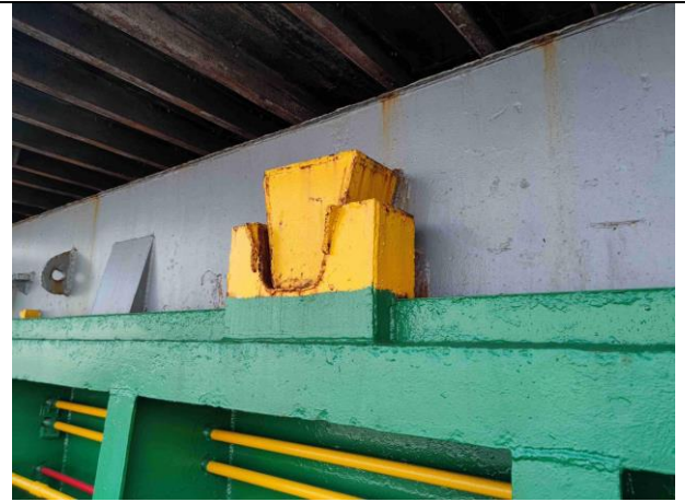
2#货舱居中位置吊离式舱盖
