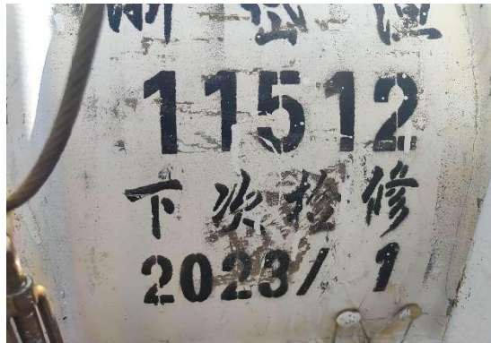
救生筏（已过检修日期）
